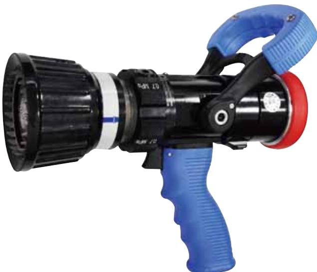
放水量はダイヤルを回す事によりOFF、110、230、360、470L/Minと自由に切替ができます。これにより現場でのホースラインの状況に応じた流量設定が手で簡単にできます。また、ハンドル部には誤操作の危険性を低減させる為のダイヤルロックトリガーを標準装備しています。ノズル先端にはタービンティースを備え、優れた自衛噴霧効果を創り出します。
