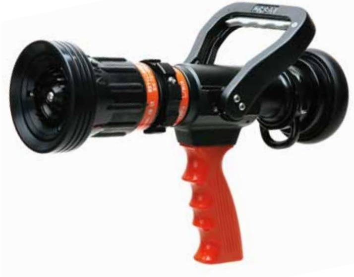
放水停止中に突然開放してしまう事故防止用のストッパー付きです。流量は115L、230L、350L、475L/0.7Mpaの4段切替。特殊回転クシ歯で完全フルコーンの噴霧状態を作ります。グリップを従来のガンタイプノズルより一回り小さくし、日本人の手のサイズに合わせました。
