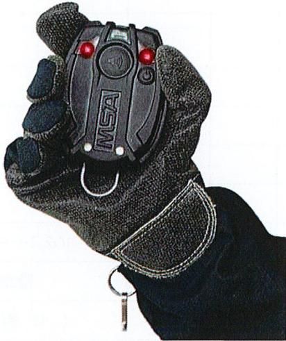
モーションスカウトは、装着者が意識を失ったり、負傷して動けなかった時、自動的に静止状態を感知し警報を発する個人用携帯警報器です。もちろん、手動で任意に警報器を鳴らすこともできます。消火・救助活動中の安全管理に有効です。静止30秒後から3段階の予備警報後、本警報となります。警報音とともに、3方向から確認できる高輝度LEDにより光でも警報を発します。ハウジング表面のシリコンラバー層により、防水、耐衝撃、耐熱性に優れた堅固なボディです。電池交換以外は、メンテナンスの必要がありません。
