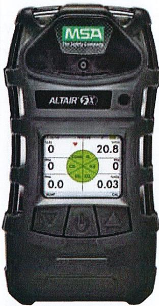
5成分のガス(可燃性ガス、酸素、一酸化炭素、硫化水素、その他有毒ガス\*)を検知対象とした、ポンプ機能内蔵のポンプ式マルチガス検知警報器です。\*その他の有毒ガスについてはお問い合わせ下さい。新世代XCellセンサーにより、過酷な環境下においても抜群の精度、再現性、安定性を誇ります。4ガスXCellセンサーにおいては3年保証という長寿命を実現しています。
